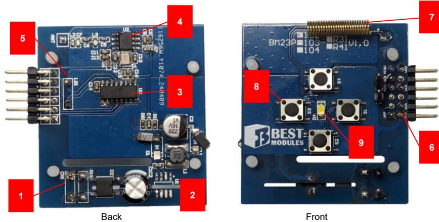
1. AC power input: 85V<sub>AC</sub> ~ 265V<sub>AC</sub>
